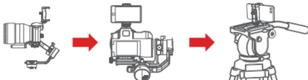
Der Telefonhalter kann nicht nur an der Oberseite der Kamera zur Objektverfolgung montiert werden, sondern auch zur Befestigung des Telefons am Stativkopf für die Mimikbewegungsverfolgung verwendet werden.
