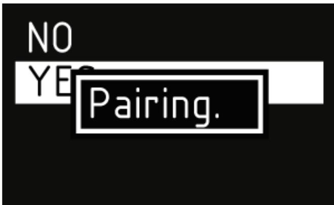
此时给云台插上电池开机，即可完成配对。配对完成后拇指控屏幕会弹出OK的提示，1秒后消失，自动回到配对的二级菜单下，返回至主界面即可控制MOZA主机。配对不成功时界面会一直显示“Pairing”，等待配对。
