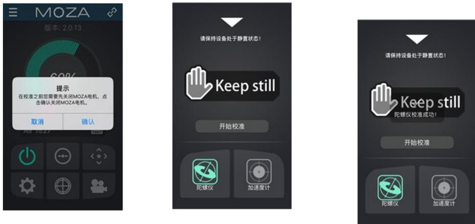
点击“陀螺仪校准/加速计校准”按钮将看到关闭电机的提示。请点击“确认”进入陀螺仪校准界面。
