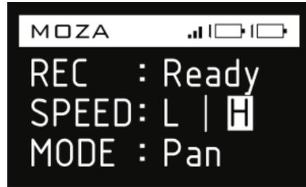
4、**控制相机录制、停止录制：**短按ON/OFF键。
