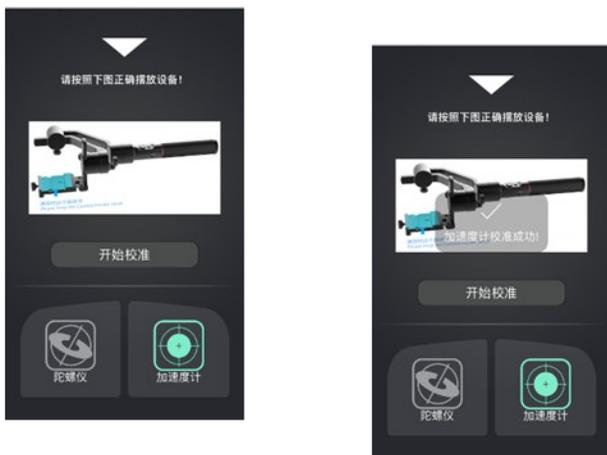
在陀螺仪校准完成后即可开始加速计校准。请先拆卸快装装置调整螺丝，然后按APP图所示姿态正确摆放设备，使云台底板保持静止水平状态，然后点击“开始校准”按钮开始加速计校准。您需要等待5-10秒加速计即可完成校准。
