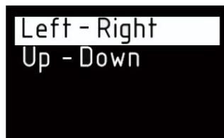
Reverse可对摇杆方向取反，用户可以根据自己的操作习惯来调节。操作方向取反与摇杆的映射状态以及4向/8向模式无关。
