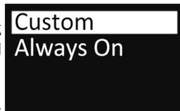
OLED屏幕熄灭后摇杆和滚轮可继续工作，OPTIONS、SPEED和ON\OFF按键的第一次短按只能点亮屏幕，不会响应对应的功能，屏幕点亮后各按键恢复功能。
