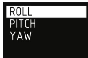
Up Down 和 Left Right 用于重新映射摇杆所控制的云台轴向。用户根据自己的需要，选择要重新映射的摇杆拨动方向（上下、左右），向右拨动摇杆，选择需要映射到的云台轴向（横滚、俯仰、航向）。映射成功后，在主界面时拨动摇杆，则对应的云台电机将运动。
