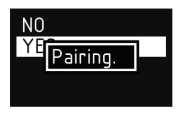
此时给云台插上电池开机,即可完成配对。配对完成后拇控屏幕会弹出 OK的提示,1秒后消失,自动回到配对的二级菜单下,返回至主界面即可控制MOZA 主机。配对不成功时界面会一直显示"Pairing",等待配对。
