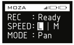
3、 选择不同档位:进入云台速度调节后,短按SPEED键,可以选择3个不同档位的云台运动速度。
