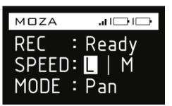
2、调节云台运动速度:长按SPEED键,进入云台速度调节;再次长按SPEED键,可切回调焦速度调节。
