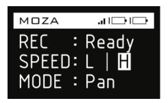
4、控制相机录制、停止录制: 短按ON/OFF键。
