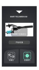
在陀螺仪校准完成后即可开始加速计校准。请先拆卸快装装置调整螺丝,然后按APP图 所示姿态正确摆放设备,使云台底板保持静止水平状态,然后点击"开始校准" 按钮开始加速计校准。您需要等待5-10秒加速计即可完成校准。
